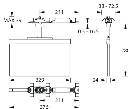
Abmessungen Lichtband-Aufnahme (BxHxT)
