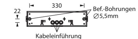
Gehäuseausführung / Casing design / Configuration logement
