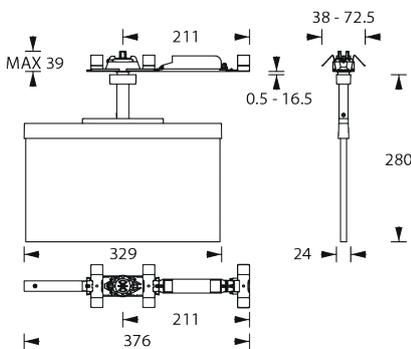
Abmessungen Lichtband-Aufnahme (BxHxT)
