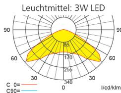
Lampenlichtstrom Not/Netz: 120lm/120lm – Nennbetriebsdauer: 8h
