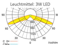
Lampenlichtstrom Not/Netz: 280lm/120lm – Nennbetriebsdauer: 1h/3h
