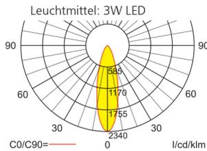
Lampenlichtstrom Not/Netz: 280lm/120lm – **Nennbetriebsdauer: 1h/3h**
