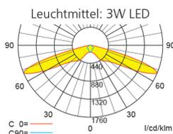
Lampenlichtstrom Not/Netz: 120lm/120lm – Nennbetriebsdauer: 8h
