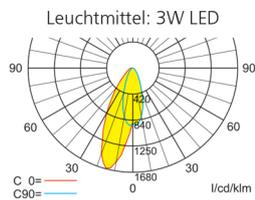
Lampenlichtstrom / Luminous flux: 280lm
