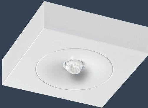
Kompakte quadratische LED-Einzelbatterie-Sicherheitsleuchte für die besonderen Anforderungen der EN 1838 an Beleuchtung von Brandbekämpfungs- und Sicherheitseinrichtungen mit 5lx, wie zum Beispiel von Feuerlöschgeräten, Feuermeldern und Erste-Hilfe-Stellen.
