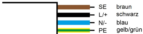
Der Flutlichtstrahler kann im DC-Betrieb in zwei Leistungsstufen DC-100% und DC-Eco betrieben werden. Durch anschließen des SE-Steuereingangs an L/+ wird der DC-Eco aktiv geschaltet. Bei erkannter DC-Spannungsversorgung leuchtet Flutlichtstrahler mit reduzierter Lichtleistung.
