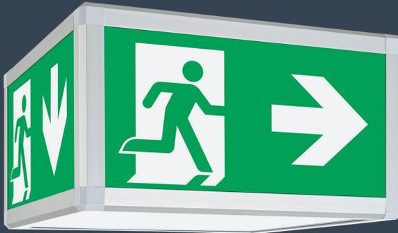
Moderne LED-Einzelbatterie-Rettungszeichenleuchte im kubischen Gehäuse mit eloxiertem Aluminium-Profil-Rahmen und klappbarem Stahlblech-Deckencontainer, IP54. Die Leuchte ist mit drei Piktogrammscheiben im Rettungszeichenformat 2:1 und einer opalen Scheibe ausgestattet. Sehr robust und schnell zu montieren.
