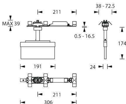
Abmessungen Lichtband-Aufnahme (BxHxT)
