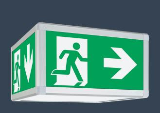
Moderne LED-System-Rettungszeichenleuchte im kubischen Gehäuse mit eloxiertem Aluminium-Profil-Rahmen und klappbarem Stahlblech-Deckencontainer, IP54. Die Leuchte ist mit drei Piktogrammscheiben im Rettungszeichenformat 2:1 und einer opalen Scheibe ausgestattet. Sehr robust und schnell zu montieren.
