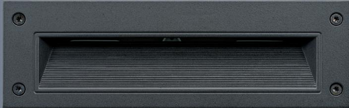
Rechteckige LED-System-Sicherheitsleuchte mit annähernd wandbündigem Leuchtenkörper zum Wand- und Stufeneinbau aus Aluminium-Druckguss, schwarz. Der Leuchtenkörper ist mit einem Hochleistungs-LED Modul ausgestattet und kann in einen Betoneinbaukasten eingesetzt werden. Ausführung entsprechend DIN EN 60598-1, DIN EN 60598-2-22 und DIN EN 1838.
