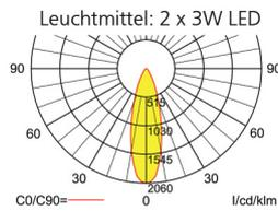
Lampenlichtstrom Not/Netz: 480lm/360lm – **Nennbetriebsdauer: 1h/3h**
