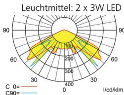
Lampenlichtstrom Not/Netz: 480lm/360lm – **Nennbetriebsdauer: 1h/3h**
