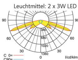
Lampenlichtstrom Not/Netz: 480lm/360lm – **Nennbetriebsdauer: 1h/3h**
