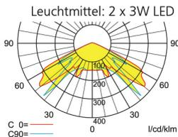
Lampenlichtstrom Not/Netz: 240lm/360lm – **Nennbetriebsdauer: 8h**
