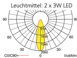
Lampenlichtstrom Not/Netz: 240lm/360lm – **Nennbetriebsdauer: 8h**
