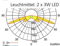
Lampenlichtstrom Not/Netz: 240lm/360lm – **Nennbetriebsdauer: 8h**
