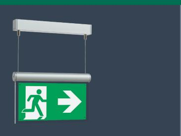
LED-Einzelbatterie-Rettungszeichenleuchte in ansprechendem, architektonischem Design durch Kombination von runden und eckigen eloxierten Aluminiumprofilen und universellem Piktogramm-Set. Ausführung für Scheiben-Seilabhängung mit separater LED-Scheibeneinheit, verbunden über zwei 1,5m lange stromführende transparente Abhängekabel (Kleinspannung). Abhängehöhe einstellbar über komfortablen Rastmechanismus. Mit einseitiger oder zweiseitiger Beschriftung erhältlich.
