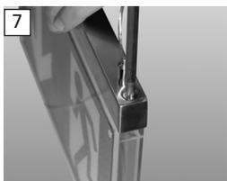
7 Lösen Sie die beiden Schrauben am Scheibenhalter und entnehmen die Scheibe.
