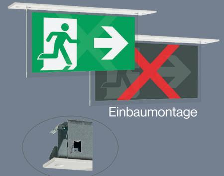
Dynamische LED-System-Rettungszeichenleuchte aus Stahlblech mit indirekt ausgeleuchteter, freihängender Transparenzscheibe. Das Piktogramm der Leuchte ist in der Lage über die Steuerkontakte der Brandmeldeanlage, zwei verschiedene Zustände (Evakuierung und Sperrung) anzuzeigen. Eine Evakuierungs-Pfeilrichtung (einseitig) ist immer auswählbar und bei der Bestellung separat anzugeben. Das Sperrsymbol ist fester Bestandteil der Scheibe und dadurch nicht abwählbar.
