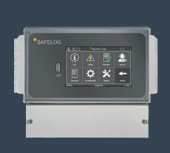
Überwachungszentrale Safelog mit Touch-Display. Je nach Ausführung können bis zu 500 busüberwachte Einzelbatterieleuchten verwaltet werden. Die Steuerung aller angeschlossenen Einzelbatterieleuchten erfolgt über ein Multitouchfähiges 5" Farbdisplay, welches die Betriebszustände der einzelnen Leuchten darstellt.
