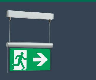
LED-System-Rettungszeichenleuchte in ansprechendem, architektonischem Design durch Kombination von runden und eckigen eloxierten Aluminiumprofilen und universellem Piktogramm-Set. Ausführung für Scheiben-Seilabhängung mit separater LED-Scheibeneinheit, verbunden über zwei 1,5m lange stromführende transparente Abhängekabel (Kleinspannung). Abhängehöhe einstellbar über komfortablen Rastmechanismus. Mit einseitiger oder zweiseitiger Beschriftung erhältlich.
