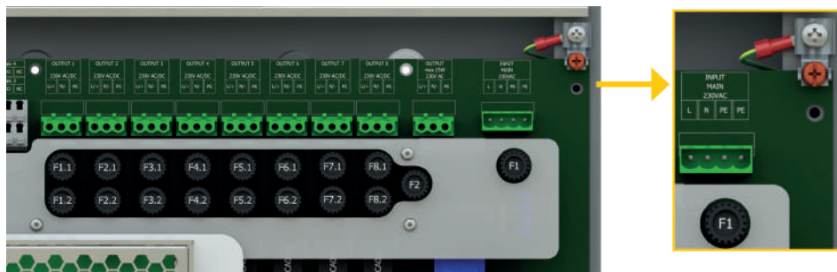
Fig. 19: Raccordement de la tension d'alimentation
