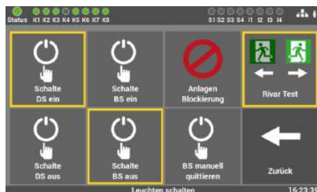
Abb. 170: Test RIVA-Leuchten gesperrt
