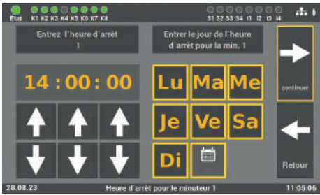
Fig. 104: Écran « Minuteries – Heure d’arrêt »
