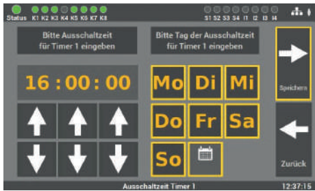
Abb. 104: Maske „Zeitschaltuhren – Ausschaltzeit“
