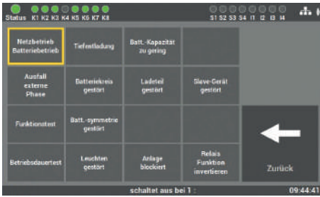
Abb. 113: Maske „Ein-/Ausgänge – Meldetableau“
