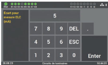
Fig. 90: Écran « Valeurs-seuils » (surveillance individuelle des luminaires)
