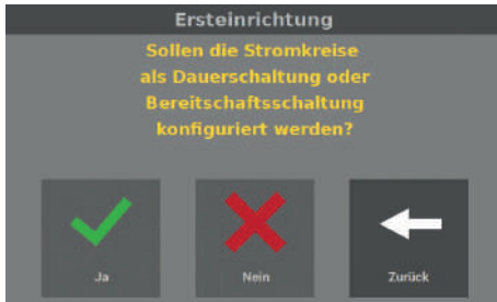
Abb. 43: Abfrage nach Schaltungsart
