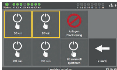
Abb. 117: Leuchten schalten – BS
