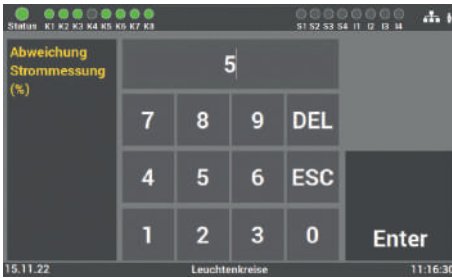
Abb. 91: Maske „Schwellwerte“ (Stromkreisüberwachung)
