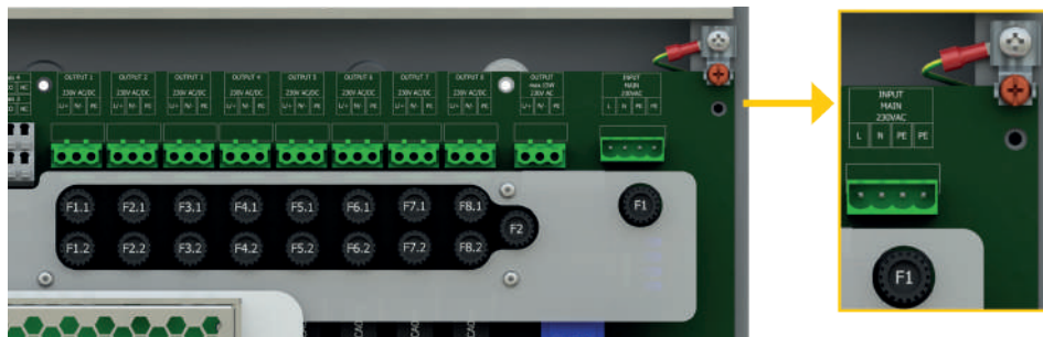
Abb. 19: Anschluss der Spannungsversorgung
