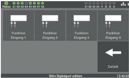
Abb. 109: Maske „Ein-/Ausgänge – potenzialfreie Steuereingänge“
