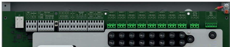
Fig. 18: Vue de la partie connexion de la carte mère
