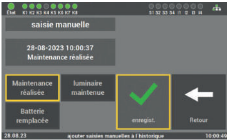
Fig. 70: Écran « Documentation manuelle – Maintenance LPS »
