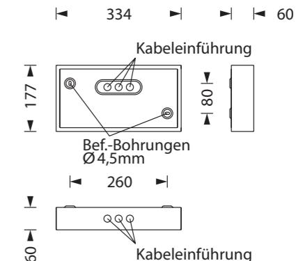
**Gehäuseausführung / Casing design / Configuration logement**
