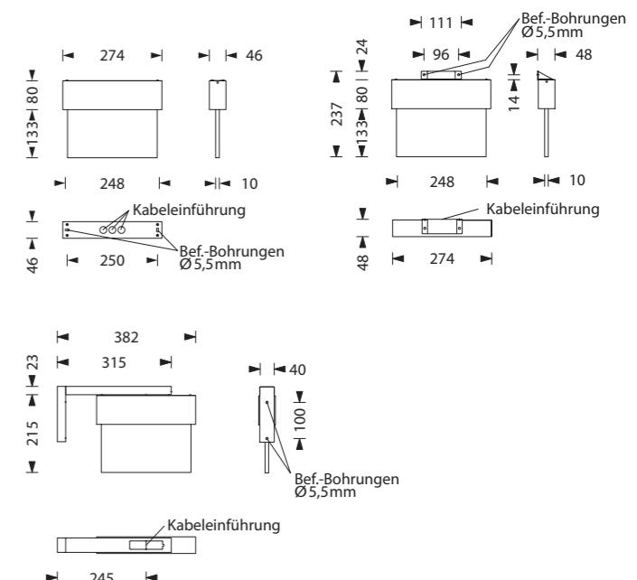
Gehäuseausführung / Casing design / Configuration logement
