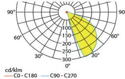
Lampenlichtstrom Not (DC)/Netz: 260lm / 140lm **Nennbetriebsdauer 8h**
