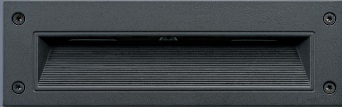
Rechteckige LED-Einzelbatterie-Sicherheitsleuchte mit annähernd wandbündigem Leuchtenkörper zum Wand- und Stufeneinbau aus Aluminium-Druckguss, schwarz. Der Leuchtenkörper ist mit einem Hochleistungs-LED Modul ausgestattet und kann in einen Betoneinbaukasten eingesetzt werden.
