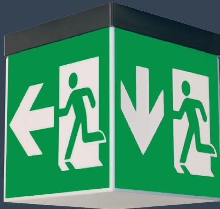
Würfelförmige LED-Einzelbatterie-Rettungszeichenleuchte mit Kunststoffsockel aus Duroplast und allseitig beschriftbarer opaler Acrylglashaube, mit universellem Piktogramm-Set. Schraubenloser, leicht zu handhabender Verschlussmechanismus. Das Gehäuse ist als Decken-, Wand-, Pendel- und Kettenmontage erhältlich.
