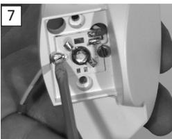
Lösen Sie die beiden LED-Modul-Befestigungsschrauben so weit, dass das LED-Modul ausgefädelt werden kann.
