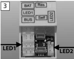
Stellen Sie die Kabel-/Erdverbindung zwischen Ober- und Unterteil wieder her und achten darauf, dass bei Einzelbatterieleuchten die Verbindung der LED zur Elektronik an Steckplatz LED1 einzubringen ist.
