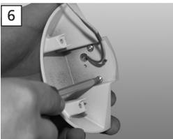
Entfernen Sie die Optik-Halteplatte durch Lösen der rückseitigen Befestigungsschrauben.
