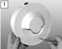
Öffnen Sie die Leuchte durch das Einstecken eines Schraubendrehers (max. Ø 2,5mm) in die Löcher des Gehäusedeckels. Trennen Sie alle Kabelverbindungen zwischen Gehäuseober- und -unterteil.
