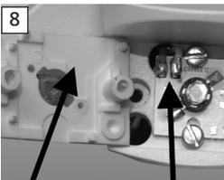
Beim Aufsetzen der Optik-Halteplatte achten Sie darauf, dass die Kabelausnehmung über den Kabeln der LED positioniert ist.
