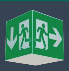
Würfelförmige LED-System-Rettungszeichenleuchte mit Metallsockel und allseitig beschriftbarer opaler Acrylglashaube, mit universellem Piktogramm-Set. Das Gehäuse ist als Decken-, Wand-, Pendel- und Kettenmontage erhältlich.
