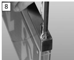
Lösen Sie die beiden Schrauben am Scheibenhalter und entnehmen die Scheibe.
