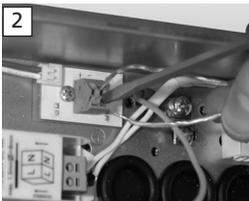
Lösen Sie alle Kabelverbindungen zwischen dem Leuchtengehäuse und der Montageplatte.
