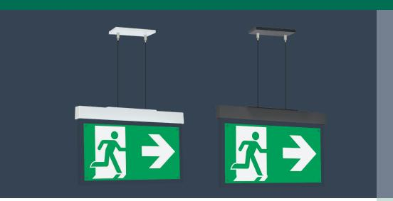
LED-System-Rettungszeichenleuchte in schlichtem und modernem Design aus hochwertigem Aluminium in weiß oder schwarz. Ausführung für Scheiben-Seilabhängung mit separater LED-Scheibeneinheit, verbunden über zwei 1,5m lange stromführende transparente Abhängekabel (Kleinspannung) mit Lichtlenkscheibe und universellem Piktogramm-Set.
