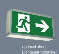
LED-Einzelbatterie-Rettungszeichenleuchte in flacher Ausführung. Aluminiumprofil silberfarbig eloxiert, mit abgerundeten Profilverbindungen und steckbarem Piktogramm-Set und unterseitigen Lichtaustrittsfenstern. Für Wartungszwecke ist die Leuchte mittels aufklappbarem Eckprofil werkzeuglos zu öffnen.
