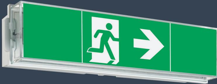
Schlanke, ansprechende LED-System-Rettungszeichenleuchte im Polycarbonatgehäuse mit klarer Haube und universellem Piktogramm-Set. Schraubenloser, leicht zu handhabender Verschlussmechanismus. Das Gehäuse ist als Wandmontage mit einseitiger Beschriftung erhältlich. Ausführung entsprechend DIN EN 60598-1, DIN EN 60598-2-22, DIN EN 1838 und DIN EN ISO 7010.
