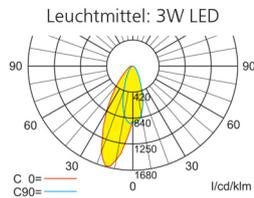
Lampenlichtstrom / Luminous flux: 280lm
