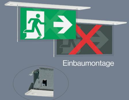
Dynamische LED-System-Rettungszeichenleuchte aus Stahlblech mit indirekt ausgeleuchteter, freihängender Transparenzscheibe. Das Piktogramm der Leuchte ist in der Lage über die Steuerkontakte der Brandmeldeanlage, zwei verschiedene Zustände (Evakuierung und Sperrung) anzuzeigen.
